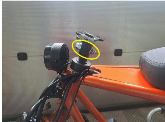
Irrota ohjaustangon pohjan pidikkeen kiinnityspultti ( 2 kpl kiintoavain 14 mm).
