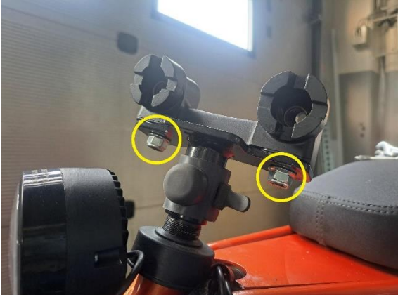
Irrota ohjaustangon pohjan kiinnitysmutterit (kiintoavain 14 mm).
